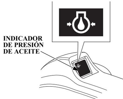
6. Compruebe si el indicador de presión del aceite pasa a posición ON. Si no se activa, detenga el motor y efectúe las inspecciones siguientes.
