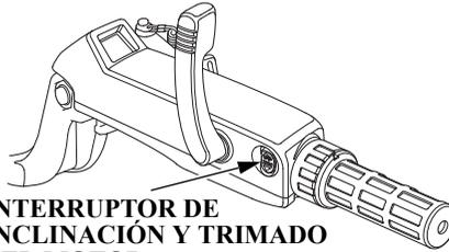
INTERRUPTOR DE INCLINACIÓN Y TRIMADO DEL MOTOR
