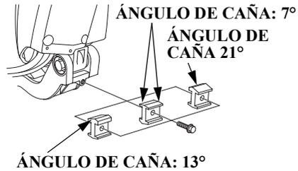
Instale bloque de ajuste de la altura para que el ángulo seleccionado de la caña del timón quede en esta posición.
