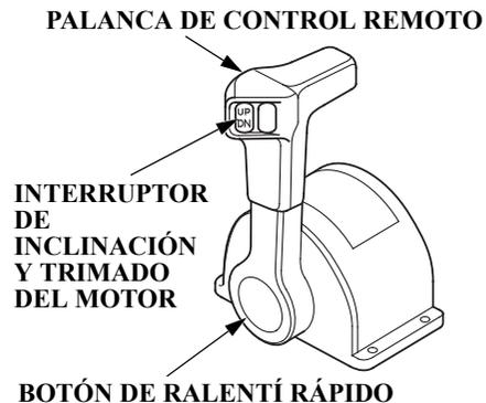
**INTERRUPTOR DE INCLINACIÓN Y TRIMADO DEL MOTOR (DERECHO)**
