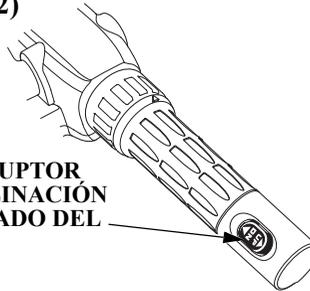
INTERRUPTOR DE INCLINACIÓN Y TRIMADO DEL MOTOR
